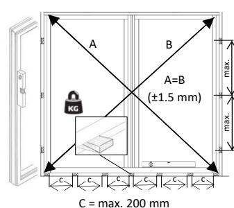
█ Uppklossning. Placera ut klossar längs med sidokarmarna och alla läs- och fästpunkter längs sidor och botten. Under bottenkarmen ska det placeras ut kompletterande klossar med en bredd på min. 50 mm för max. varje 200 mm. Monter karmen helt lodrät med hjälp av vattenpass och kryssmått ( $\pm 1.5\text{ mm}$ ), så att skjutdörren kan köra optimalt.
